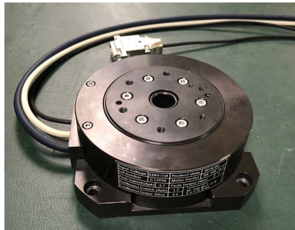
Encoder ottico ATOM su una piattaforma rotante di piccole dimensioni
