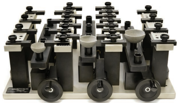
定制夹具用于同时固定具有多种尺寸的一系列工件。
