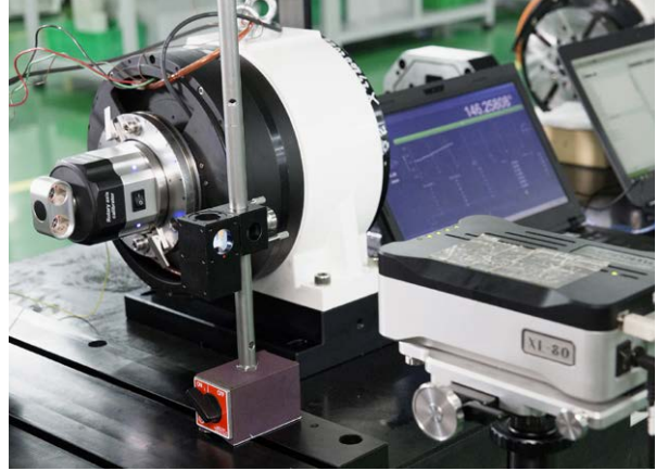
吳志的線性馬達和直驅轉台均採用了 Renishaw XL-80 雷射干涉儀搭配 XR20-W 旋轉軸校正儀進行檢測
